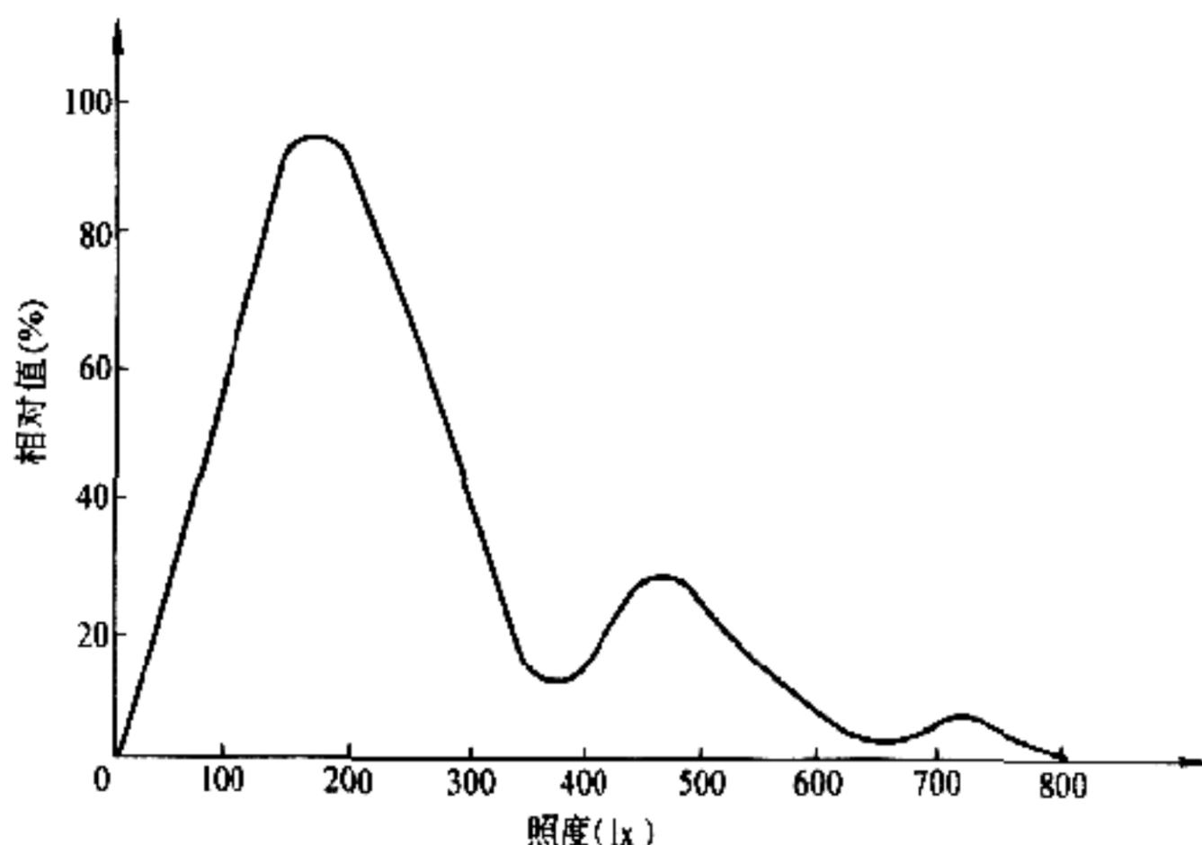
图 3 洁净车间工作面上的最低照度
