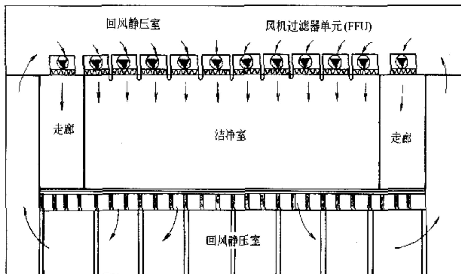
图2 风机过滤器单元送风方式(FFU)示意图
